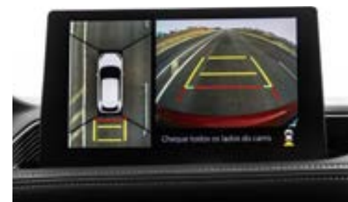
Cámara de estacionamiento 360°. (1)
