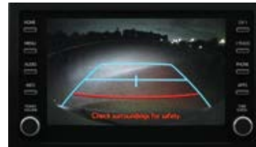
Monitor con cámara de estacionamiento.
